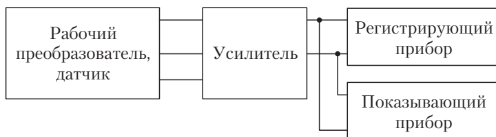
Рис. 4.7. Принципиальная схема аппаратуры для измерения неэлектрических величин электрическими методами
